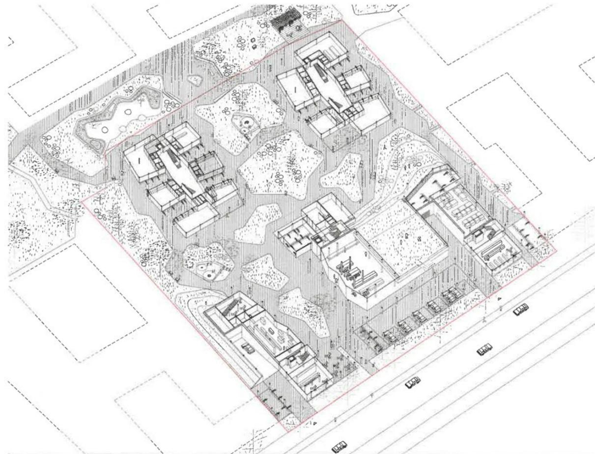
Axonometrie. Das durchlässige Erdgeschoss des Gesamtprojekts ist frei von Wohnnutzung gedacht. Hier mit den ursprünglich vorgesehenen zweigeschossigen Hallen.
